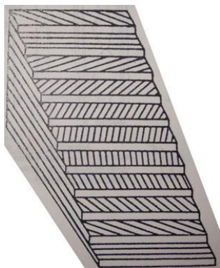
Fig. 15. Structure en contreplaqué de la paroi secondaire. ★★
